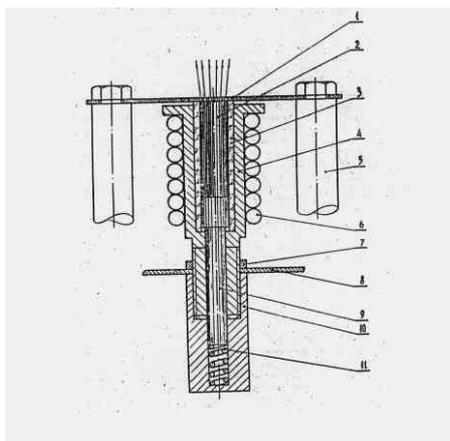
**Рис. 2-1.** Схема испарителя для напыления пленок многокомпонентных ХСП.
